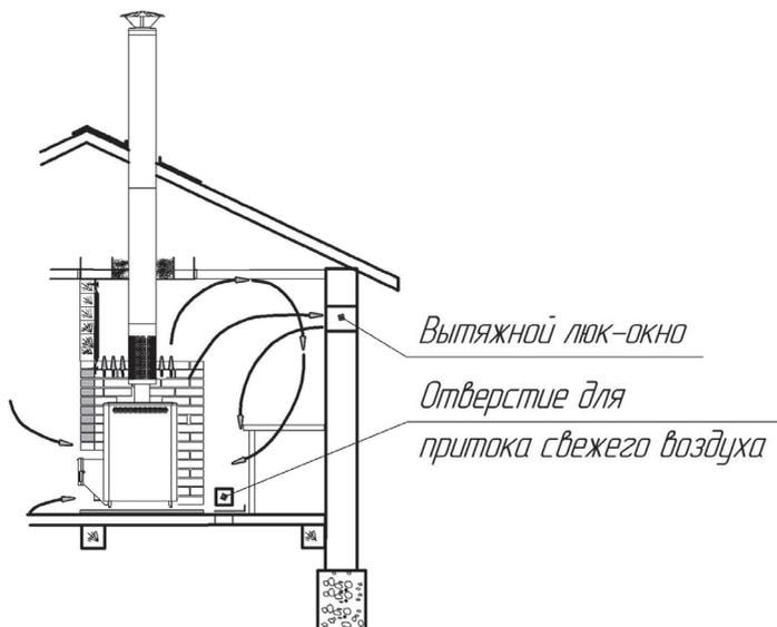
Рис. 5 Схема воздухообмена в парилке
