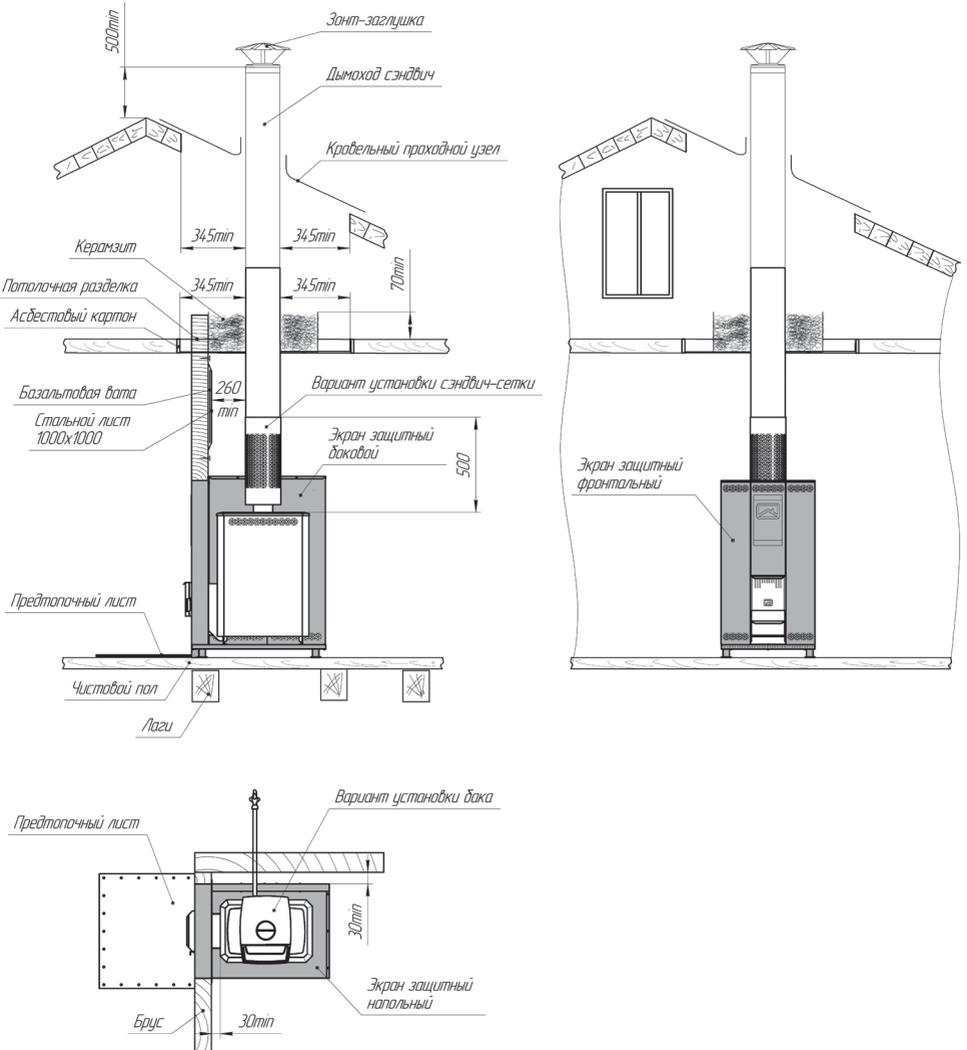
**Рис. 3** Схема установки печи с защитными экранами
