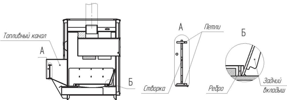
Рис. 6 Б. Установка заднего вкладыша под уголь и створки в топку печи
