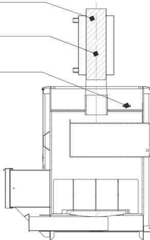
Рис. 7 Схема прочистки печи.
