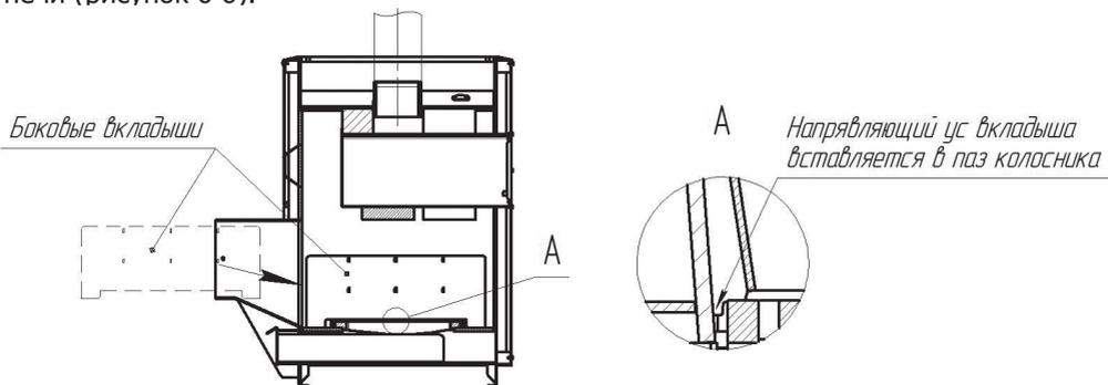
Рис.6 а. Установка боковых вкладышей под уголь в топку печи
