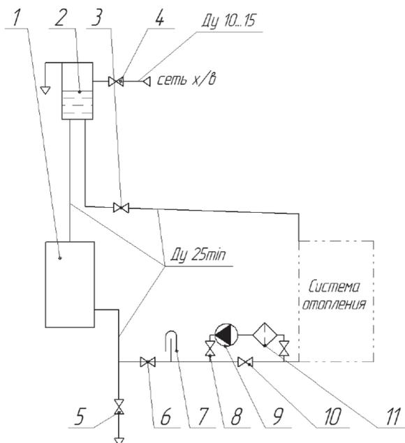
[1] Котёл. [2] Бак расширительный. [3] Кран подачи. [4] Кран подпитки системы. [5] Кран дренажа. [6] Кран обратки. [7] Термометр обратки. [8] Кран линии насоса. [9] Насос. [10] Кран байпасный. [11] Фильтр сетчатый.
