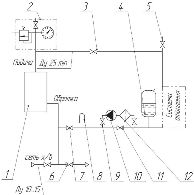
[1] Котёл. [2] Группа безопасности. [3] Кран подачи. [4] Расширительный бак. [5] Воздушный клапан. [6] Кран дренажа. [7] Кран обратки. [8] Термометр обратки. [9] Кран линии насоса. [10] Насос. [11] Кран байпасный. [12] Фильтр сетчатый.
