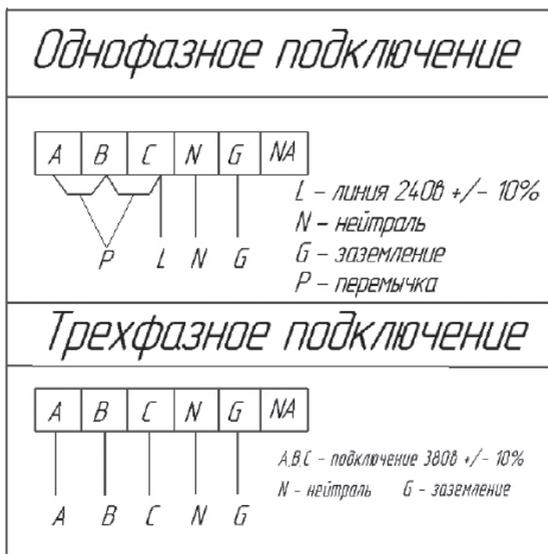
Рис. 4. Схемы подключения электрического котла к электросети.
