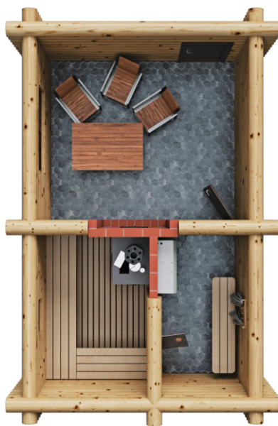
Рис. 9 Пример установки печи в кирпичном кожухе с функцией обогрева комнаты отдыха и моечного отделения
