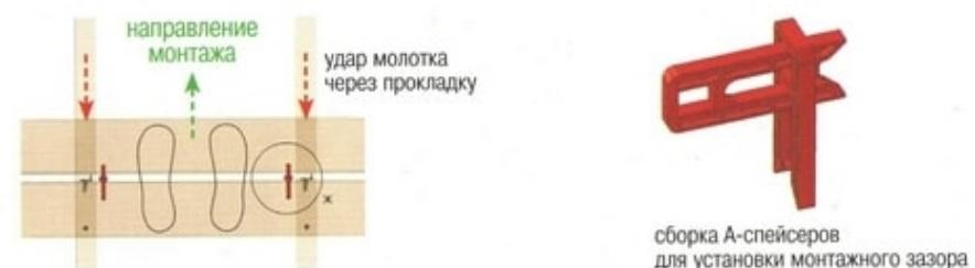
6. Повторяем действия 2-5, удаляем А-спейсеры только после монтажа всей конструкции террасы, свободный край последней доски фиксируем шурупами.
