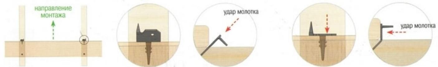
4. Устанавливаем гвоздь в отверстие крепежа и забиваем его в доску.
