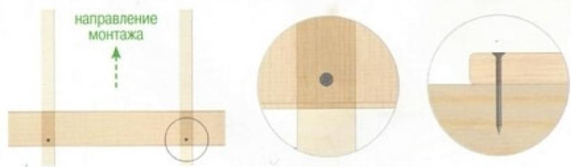
2. Устанавливаем крепеж вертикально вплотную к доске и легким ударом молотка по головке крепежа намечаем место входа крепежа в основание. Не вынимая острие якоря крепежа из основания, левой рукой наклоняем его до угла 45-60° и начинаем забивать молотком, придерживая рукой.
