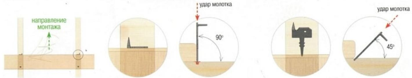
3. Ударом молотка забиваем якорь крепежа в основание, затем ударом молотка приводим головку крепежа в вертикальное положение.
