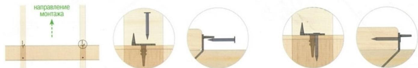
5. Устанавливаем вторую доску на основание, устанавливаем сборку А-спейсеров, встаем на доски как показано на рисунке, ударами молотка через прокладку набиваем вторую доску на шипы крепежа.
