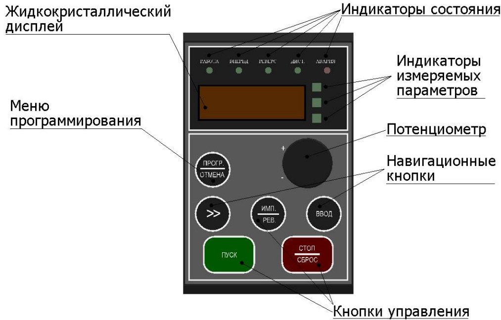
Рис. 6 Функции кнопок преобразования частоты.
